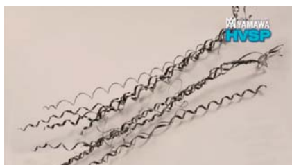
Извлечённая стружка после работы метчиком большого размера
